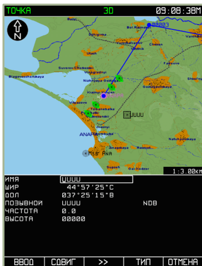
7-114: Ввод типа навигационной точки – NDB (ОПРС)
