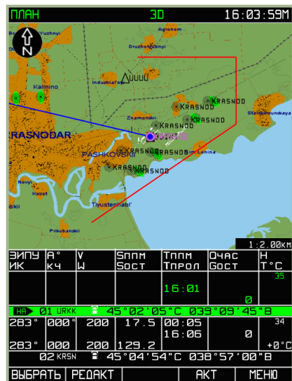
7-81: Вид дисплея после загрузки плана полета
