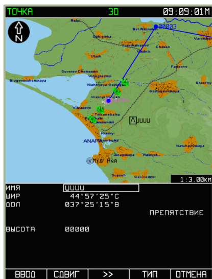
7-116: Ввод типа навигационной точки – ПРЕПЯТВИЕ
