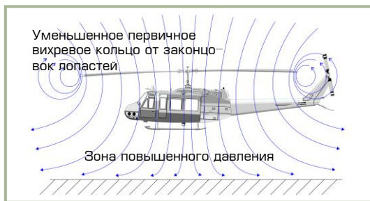
4-15: Схема воздушных потоков с учетом эффекта земли
