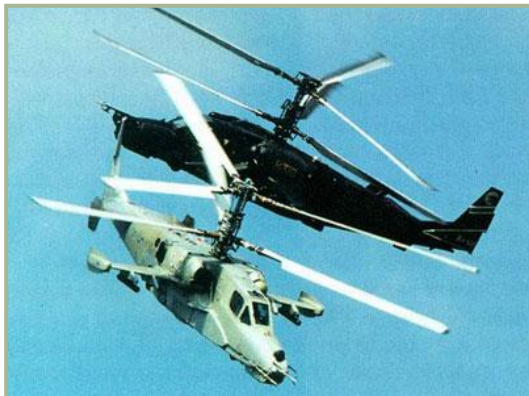
1-10: Вертолет В-80 №12 (на переднем плане) с макетом ночной прицельной станции «Меркурий» в носовой части
