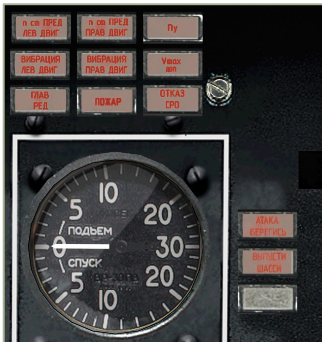
6-28: Табло светосигнальное САС левой приборной доски
