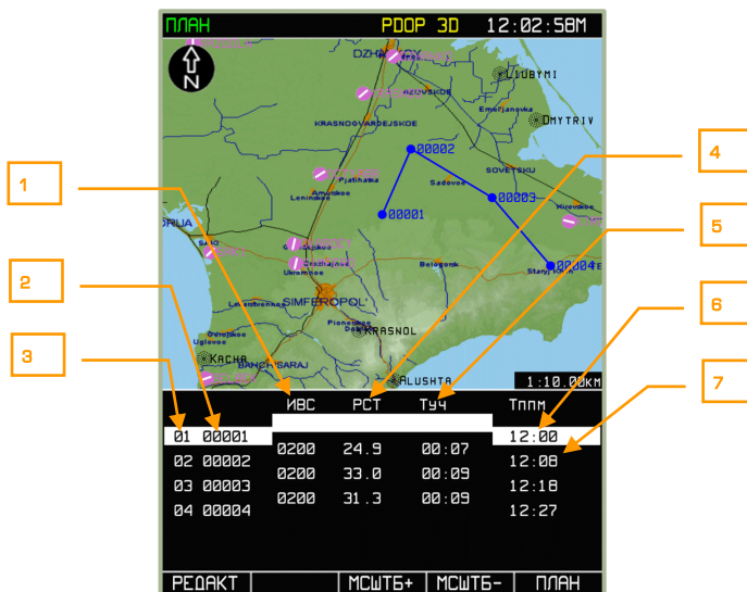
7-55: Ввод времени вылета из ИПМ и истинной воздушной скорости
