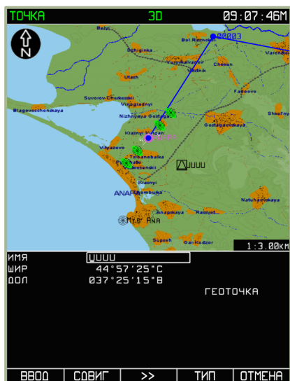
7-111: Ввод типа навигационной точки – ГЕОТОЧКА
