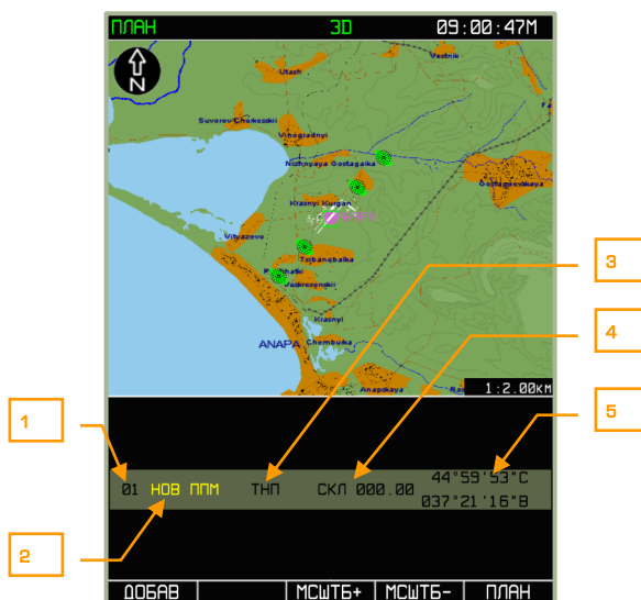
7-46: Исходное состояние дисплея при вводе первого ППМ плана полета
