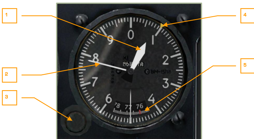
6-15: Высотомер механический BM-15ПВ
