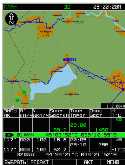
7-43: Вид дисплея в подрежиме ПЛАН
