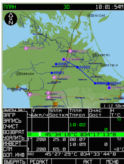
7-104: Выбор функции инвертирования плана полета
