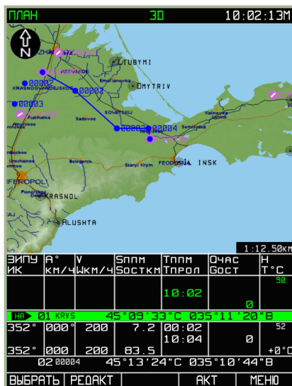
7-105: Результат инвертирования плана полета
