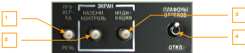
6-67: Пульт контроля системы ЭКРАН, кнопка проверки речевого информатора АЛМАЗ, выключатель плафонов отсеков
