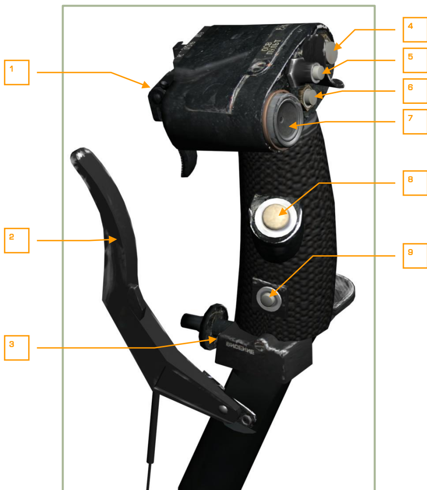
6-4: Ручка продольно-поперечного управления (ППУ)
