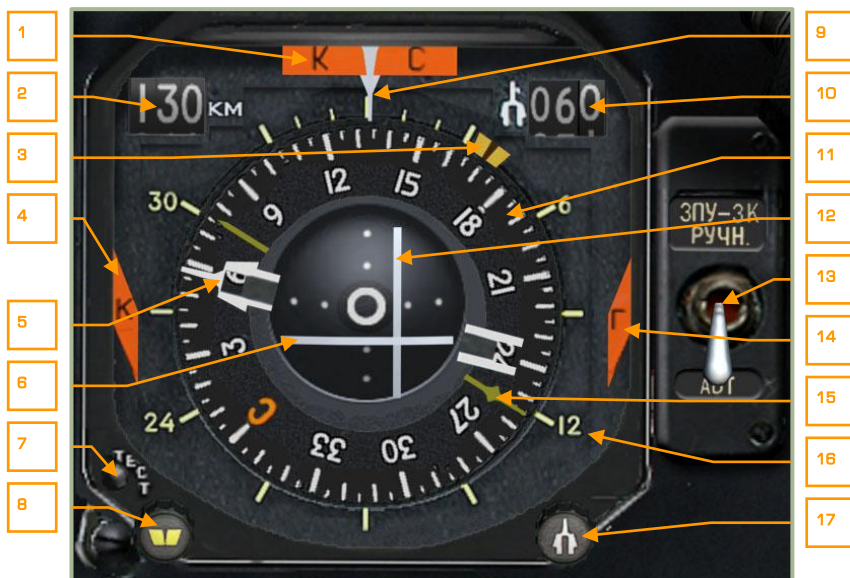
6-12: Прибор навигационный плановый ПНП-72-16
