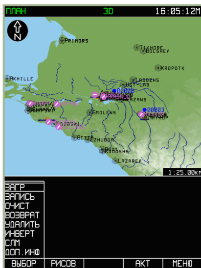
7-79: Вид дисплея при вызове функции ЗАГРУЗИТЬ
