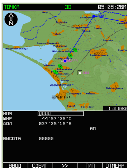
7-112: Ввод типа навигационной точки – АП (АЭРОПОРТ)
