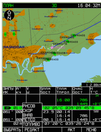
7-66: Выбор функции определения параметров атмосферы по маршруту полета METEO
