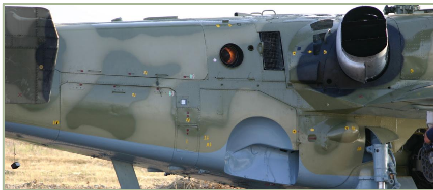
2-3: ЭВУ двигателя и выхлопное устройство вспомогательной силовой установки (в работе)
