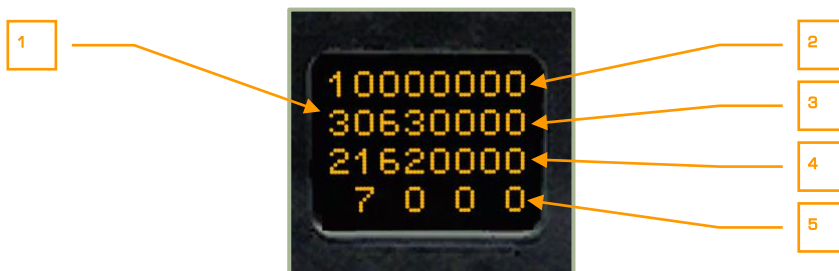
6-23: Цифровые коды сигналов, поступающих на распечатку через 8 с после посадки
