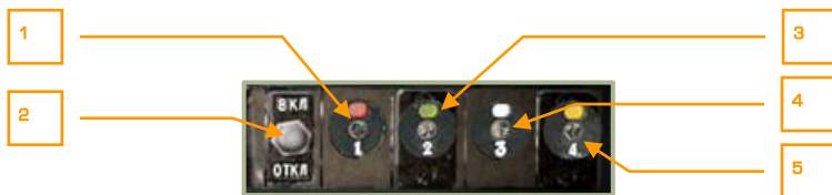
6-49: Пульт управления сигнальными ракетами
