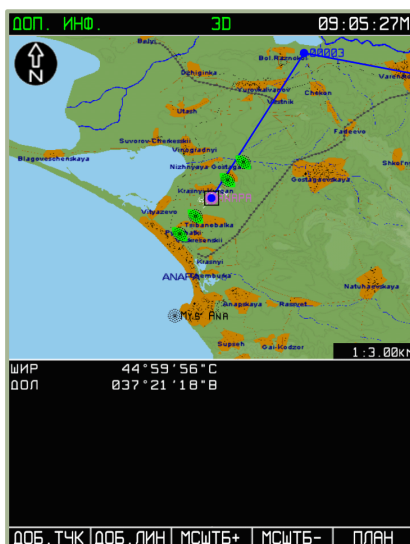
7-109: Вид дисплея в режиме ввода дополнительной информации
