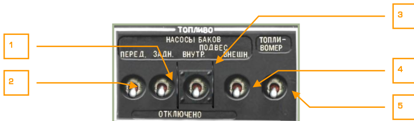
6-54: Пульт правый боковой, панель управления топливными насосами
